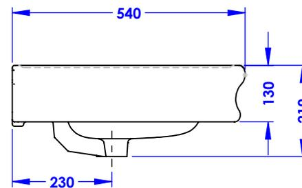
Ø de perçage et entre-axe recommandés.
